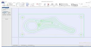
CIMCO CNC-Calc ist eine Erweiterung für CIMCO Edit und ermöglicht dem Programmierer in der Werkstatt das Erstellen von 2D-Geometrie und das Generieren von dazugehörigen NC-Sätzen – für Fräsen und Drehen. Die NC-Sätze können direkt graphisch simuliert werden.
